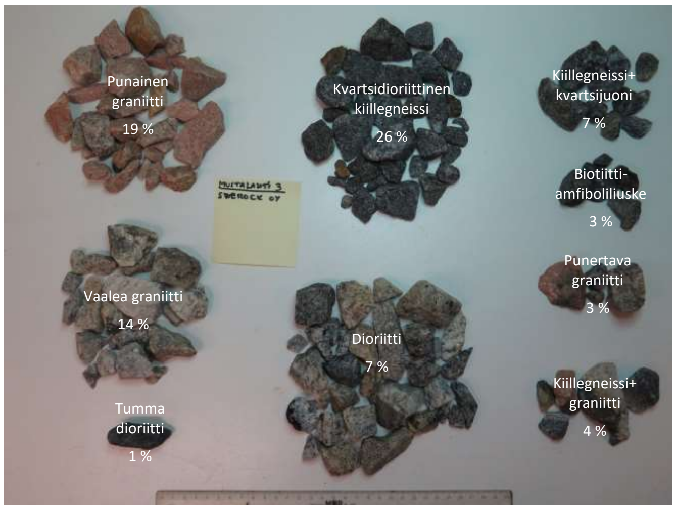
Kuva 1. Kalliomurskenäyte, josta tutkittu ohuthienäyte on valmistettu.
