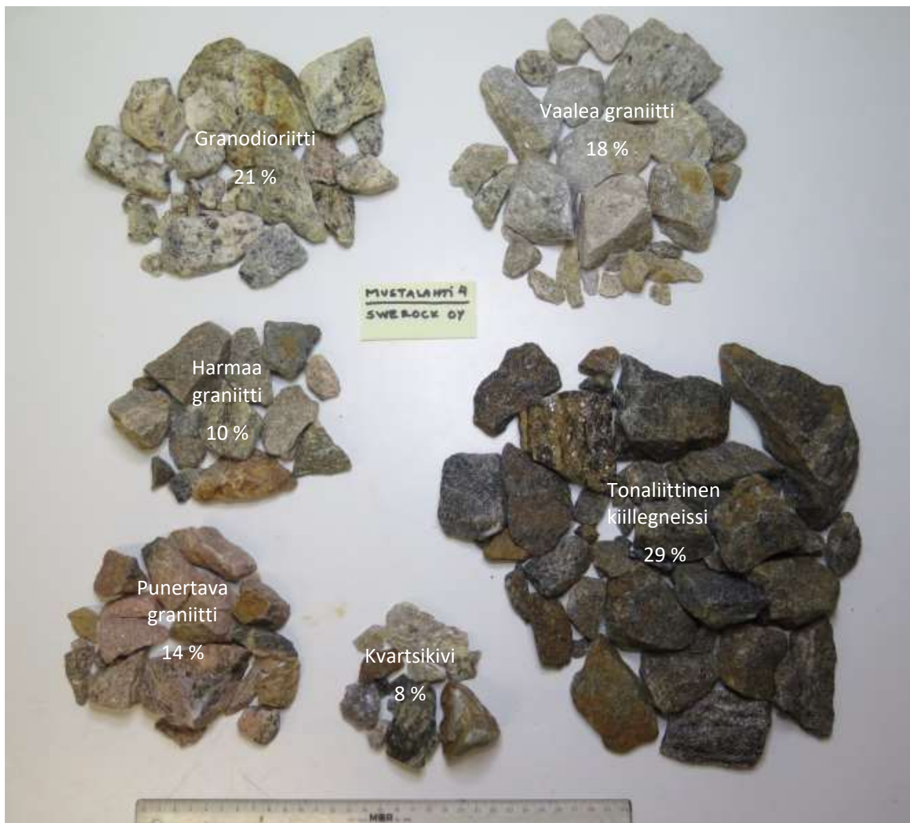
Kuva 1. Kalliomurskenäyte, josta tutkittu ohuthienäyte on valmistettu.
