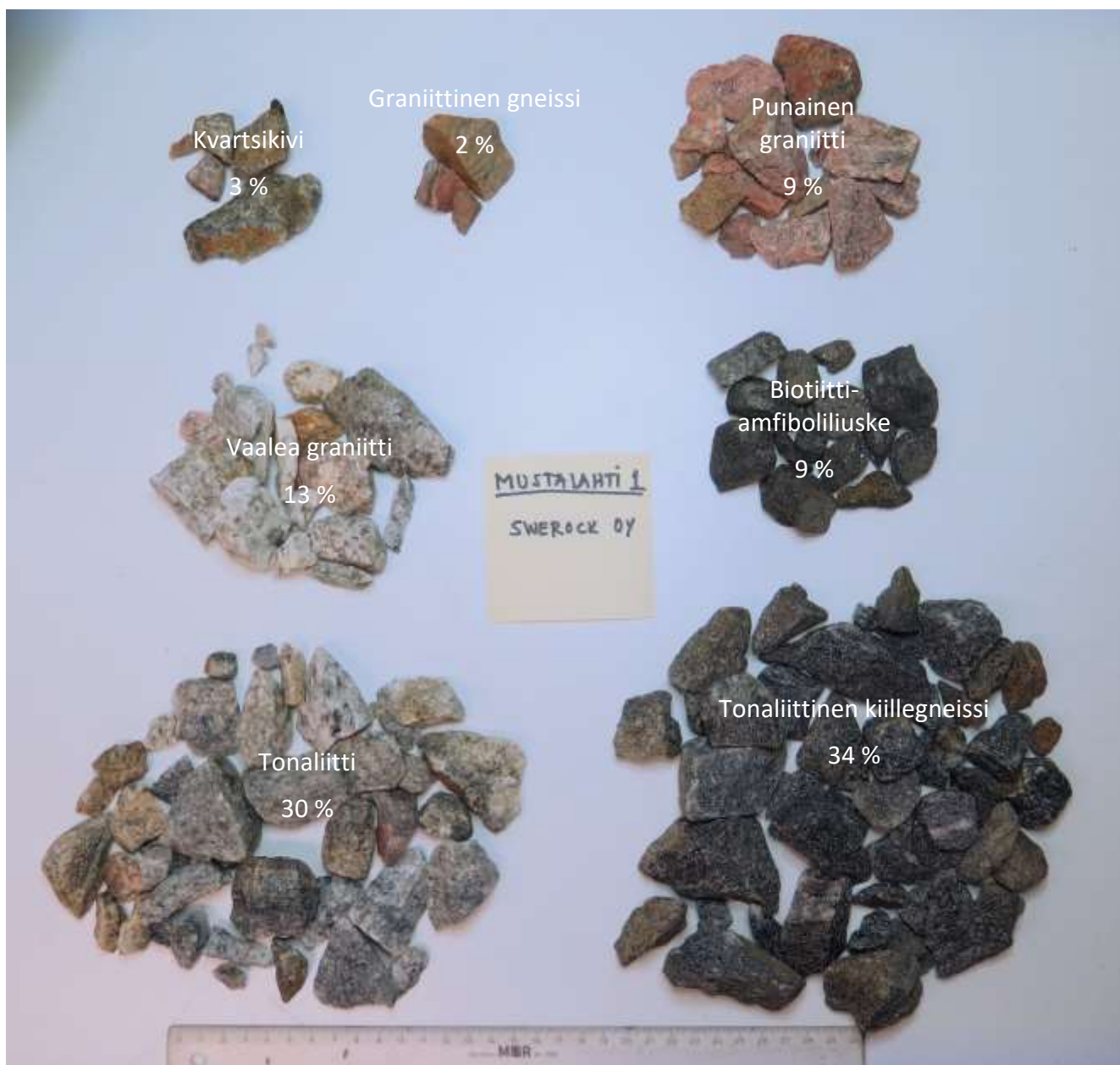
Kuva 1. Kalliomurskenäyte, josta tutkittu ohuthienäyte on valmistettu.
