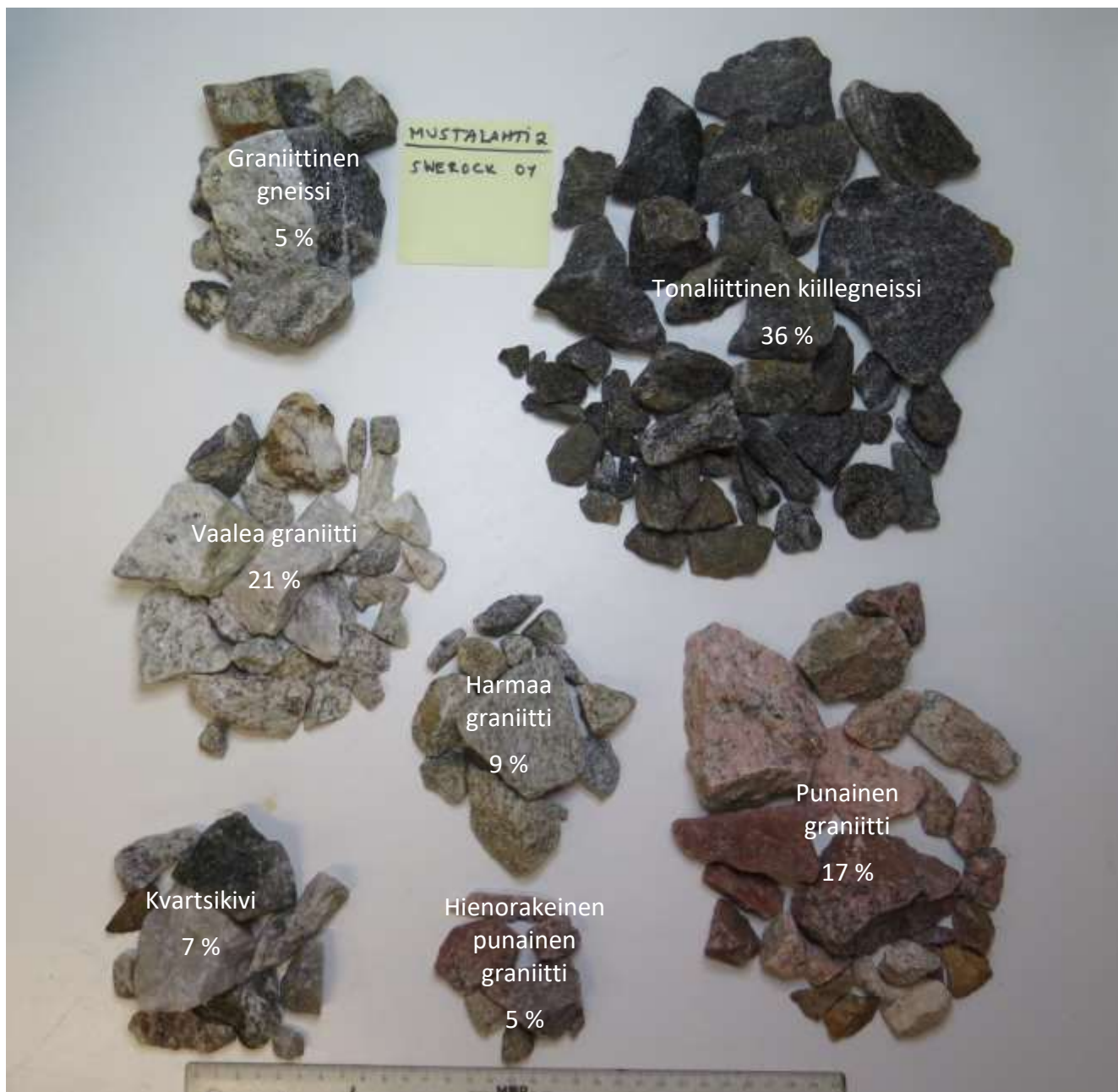
Kuva 1. Kalliomurskenäyte, josta tutkittu ohuthienäyte on valmistettu.
