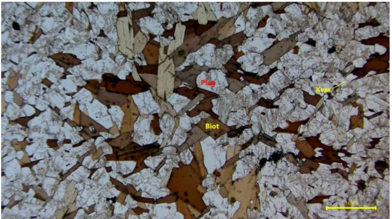
Kuva 3. Kvartsidioriittinen kiillegneissi. Kuva on otettu polarisaatiomikroskoopilla tasopolaroitua valoa käyttäen.
